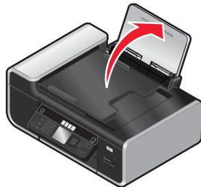
**4** Se for necessário instalar o painel de controle correto para o seu idioma, abra a impressora e levante o painel de controle.
