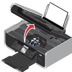
**3** Pressione a trava do suporte do cartucho para baixo de forma a levantar a tampa do suporte.
