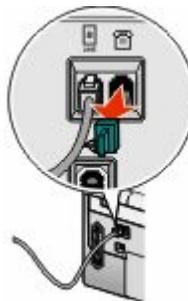
4 Ligue a outra extremidade do cabo telefónico a um telefone e, em seguida, ligue-o à porta EXT
