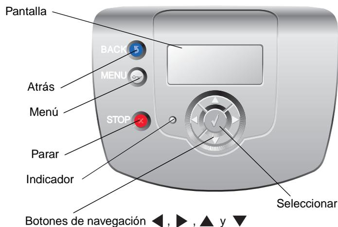
En la tabla siguiente se describe el uso de los botones y el diseño del panel del operador.
