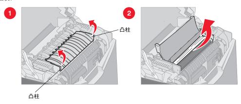
如果被卡的介质一部分在熔印部件的下面,一部分暴露在熔印部件后面的槽中,操作面板指示 202.xx Paper Jam (202.xx 卡纸)。
