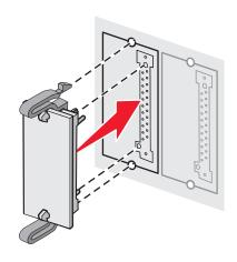
注意: 卡上的连接器必须与系统板完全接触。小心不要损坏连接器。
