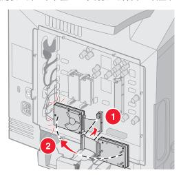
9 重新安装金属盖板。请参阅重新安装系统板金属盖板。
