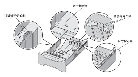
**注意**:如果再次加载相同的介质尺寸,进纸匣不需要从支持部件中完全取出。只需部分取出并加载介质,而不用调整导片。
