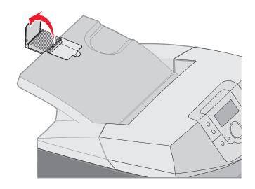
要关闭介质挡板,向前并向下折叠伸缩架。抬起介质挡板,然后将它向下折叠回关闭位置。
