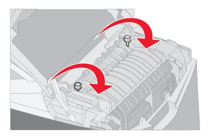
警告: 确认在关闭上部盖门之前完全拧紧翼形螺钉。
