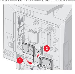
**3** 重新安装金属盖板。请参阅**重新安装系统板金属盖板**。
