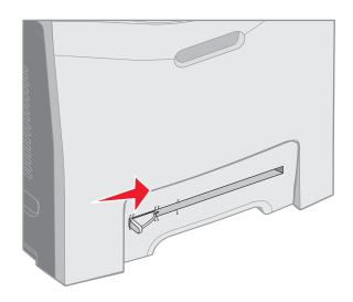
2 加载一张介质。加载介质使它与手动进纸槽的右边平直地对齐。 加载信封时使封舌面朝上并放在左边。信封的方向与加载多功能进纸器时相同。对于图示,请参阅第 56 页。
