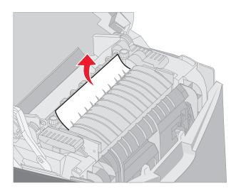
3 关闭下部盖门。这将关闭内部盖门。关闭上部盖门。
