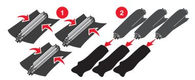
5 将光电辊部件放入随替换部件附带的箱子中。如果箱子不可用,则用一个空的纸张包装箱代替。
