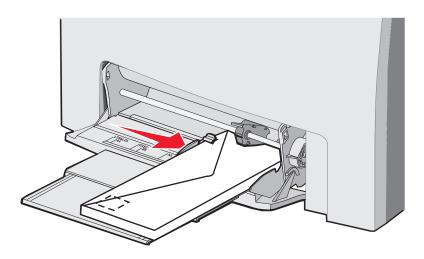
警告: 永远不要使用带有邮票、卡扣、摁扣、窗口、涂层或自动粘胶的信封。这些信封可能会严重损坏打印 机。不要将贴有邮票的信封送入多功能进纸器中。图示中显示的邮票只是表示位置。
