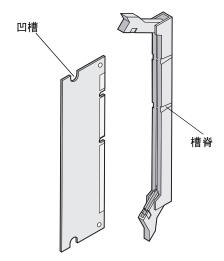
5 将内存卡笔直推入连接器中直到它咬合到位。确认每个线夹都卡在内存卡两边的凹槽上。
