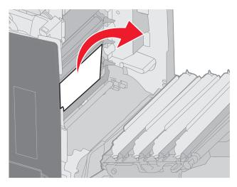
3 关闭下部盖门。这将关闭内部盖门。关闭上部盖门。
