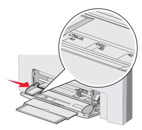
• 如果不加载纸张,将导片推到最左边。
