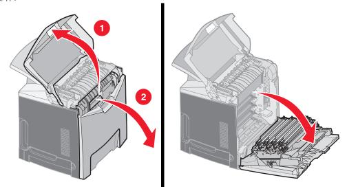
**3** 抓住光电辊部件右边的旋钮并向上提以释放光电辊部件,然后用手柄抬起光电辊部件。 左边的图示显示如何移除其中一个部件的详情,但如右图所示,必须移除所有三个彩色光电辊部件。
