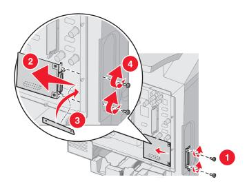
5 重新安装系统板金属盖板,请参阅重新安装系统板金属盖板。
