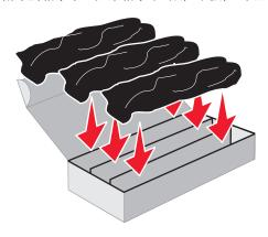
6 合上箱子以保护光电辊部件不被暴露在光线中。
