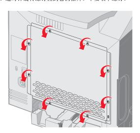
2 向上抬金属板直到每个螺钉在栓孔中。
