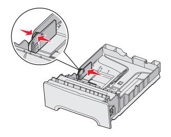
**3** 如图所示,同时压住长度导片凸柱,将长度导片滑动到与加载的纸张尺寸相符的正确位置上。对于设置、加载信纸还是 A4,根据您所在国家或地区的标准尺寸来确定。注意位于导片两边进纸匣底部的尺寸指示标志。利用这些尺寸指示标志来帮助将导片放置在正确的位置上。注意宽度导片凸柱上的加载线,它是加载介质的最大高度指示线。
