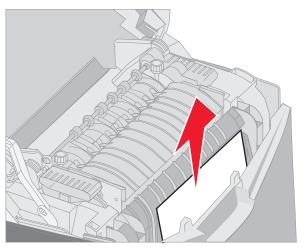
**注意**:如果打开上部盖门时不能看到大部分被卡的介质,则打开下部盖门以取出卡纸。如果要打开下部盖门而不同时打开内部盖门,拉下部盖门手柄。*不要*拉内部盖门手柄,否则内部盖门和下部盖门将一起拉下。
