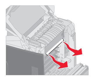
**b** 如果看不见被卡的介质,则抓住熔印部件盖板上的凸柱并抬起它。抓住被卡的介质并向上拉出。关闭熔印部件 盖板。
