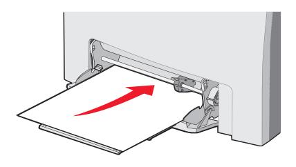
**12** 向右滑动宽度导片直到它轻轻接触到透明胶片、卡片纸或信封堆的边缘。对于纸张,导片已在加载纸张之前放置好;然而,请查看导片是否需要进行细微的调整。
