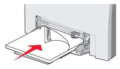
• 加载透明胶片时使推荐的打印面朝下,并让顶部边缘先进入。
