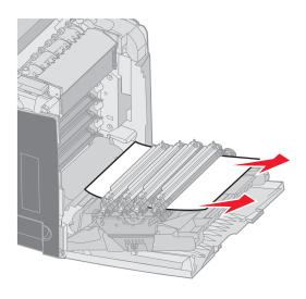
**3** 如果不能完全拉出介质,则取出所有四个光电辊部件。(如果需要取出它们的帮助,请参阅**第31页**上的图示。)清除被卡的介质,然后重新安装光电辊部件。
