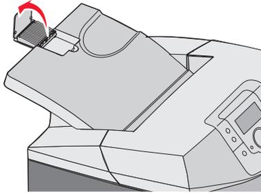
Zum Schließen des Papieranschlags klappen Sie die Verlängerung nach vorne und nach unten. Drehen Sie den Papieranschlag wieder so weit zurück, bis er sich in der geschlossenen Position befindet.
