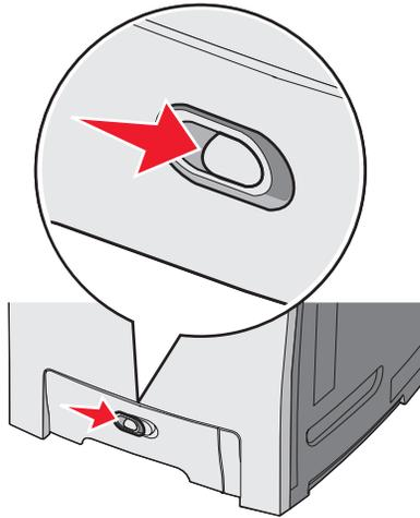
2 Ziehen Sie die Klappe der Universalzuführung nach unten.
