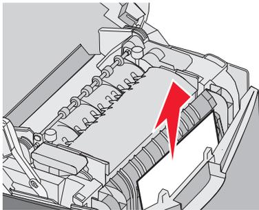
**Hinweis:** Wenn Sie mehr Platz zum Greifen des Papiers benötigen, öffnen Sie die untere Klappe, indem Sie am Griff der Klappe ziehen.
