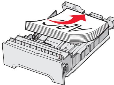
**6** Drücken Sie die Seitenführungshebel zusammen, und verschieben Sie die Seitenführung, bis sie die Seite des Stapels leicht berührt.
