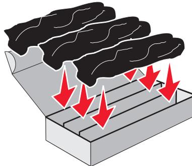
**6** Schließen Sie den Karton, damit die Fotoleiter keinem Licht ausgesetzt werden.
