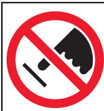
**Avvertenza:** i componenti elettrici della scheda di sistema possono essere facilmente danneggiati dall'elettricità statica. Prima di toccare un componente o connettore elettronico della scheda di sistema, toccare un oggetto metallico.
