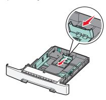
**Nota:** Utilizzare gli indicatori delle dimensioni sul fondo del vassoio per posizionare la guida.
