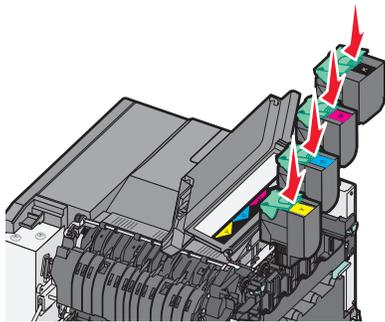
Setzen Sie die neue Druckkassette in das Belichtungs-kit ein, indem Sie die Rollen der Druckkassette auf die Schienen des Belichtungs-kits ausrichten. Schieben Sie die Druckkassette so ein, dass sie *hörbar* einrastet.
