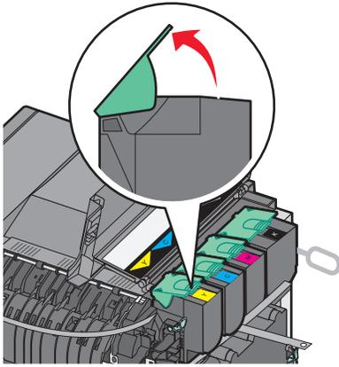
Nehmen Sie die Druckkassetten aus dem Drucker, indem Sie die Griffe nach oben drücken und dann die Kassetten vorsichtig vom Belichtungskit weg ziehen.
