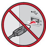
Schließen Sie das USB-Kabel erst an, wenn die entsprechende Anweisung erfolgt.
