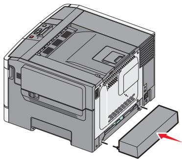
Installare la copertura antipolvere.
