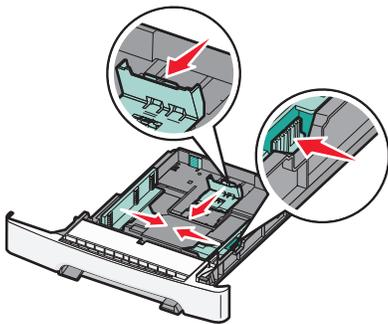
如图所示，压住右纸张导片上的宽度导片凸柱，然后将宽度导片滑动到进纸匣的两边。请注意当您只移动右纸张导片时，两个宽度导片同时移动。
