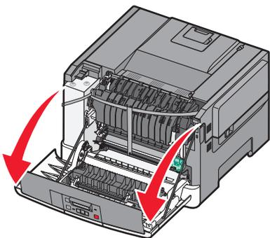
抓住前部盖门上的侧把手，然后朝着您的方向拉来打开前部盖门。
