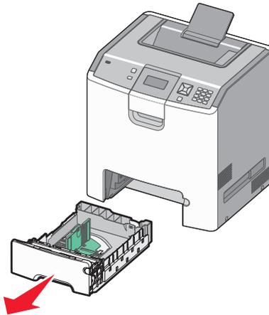
Observe los indicadores de tamaño de la parte inferior de la bandeja. Utilícelos como ayuda para la colocación de la guía.
