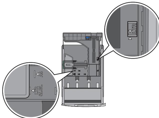
2 幅ガイドタブを図のように締め付け、セットする用紙のサイズに適した位置にスライドさせます。
