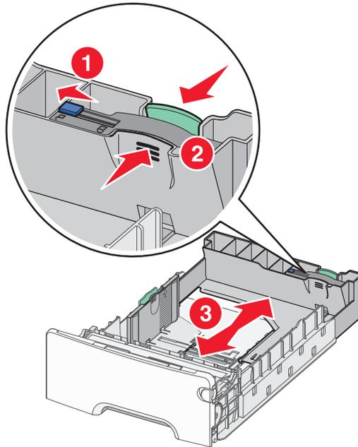
用紙カセットの左側にあるセットラインに注意してください。このラインは、用紙をセットできる最大の高さを示します。
