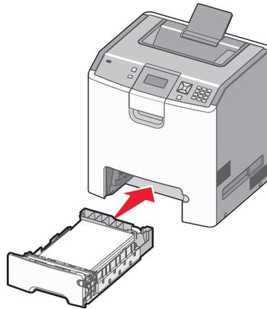
7 カセットに以前にセットされていたタイプとは異なるタイプの用紙をセットした場合は、プリンタの操作パネルでカセットの用紙のタイプ設定を変更します。詳細については、3 ページの「用紙のサイズとタイプを設定する」を参照してください。
