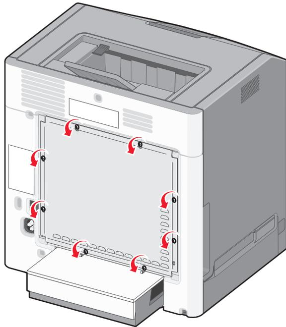
**b** Faites glisser le capot vers le haut jusqu'à ce que chaque vis se retrouve dans l'orifice principal.
