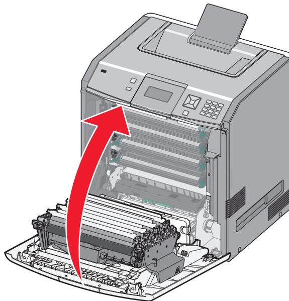
8 Si les messages **84 Rempl. photoconducteur <couleur>**, **84 Photoconduct. <couleur> presque bas** ou **84 Photoconduct. <couleur> bas** s'affichent à l'écran, appuyez sur la flèche vers le haut ou vers le bas jusqu'à ce que **✓Remp. effectué** apparaisse, puis appuyez sur .
