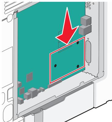
**Remarque :** Si un ISP optionnel est installé, le disque dur de l'imprimante doit être installé sur cet ISP.
