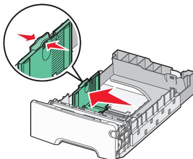
Sur le côté gauche du tiroir, un repère de chargement indique la hauteur maximale de chargement du papier.
