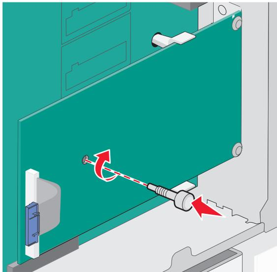
9 Vissez les deux vis fournies pour fixer le support d'installation du port ISP au boîtier de la carte logique.
