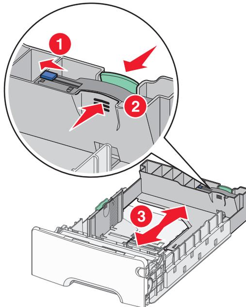
**Remarque :** le guide de longueur dispose d'un dispositif de verrouillage. Pour déverrouiller le tiroir, faites glisser le bouton situé sur le dessus du guide vers la gauche comme illustré. Pour verrouiller le tiroir une fois la longueur sélectionnée, faites glisser le bouton vers la droite en position initiale.
