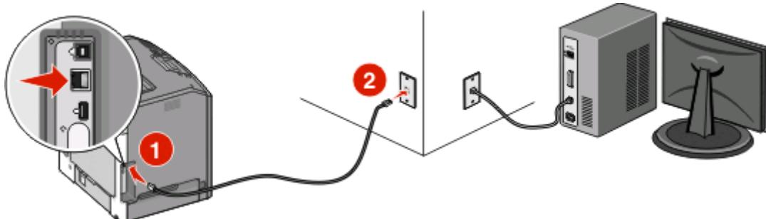
Vær sikker på den computer du bruger til at konfigurere printeren er sluttet til et fungerende netværksstik der også er på samme netværk som printeren.
