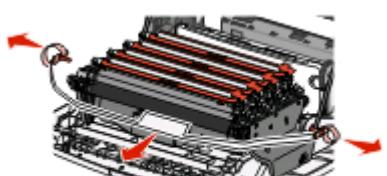
Træk hver side af pakkestripen, og træk det derefter fremad for at fjerne det fra overføringsbæltet.
