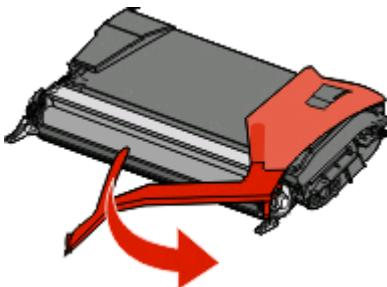
Fjern det røde inpakningsmateriale for hver tonerkassette.
