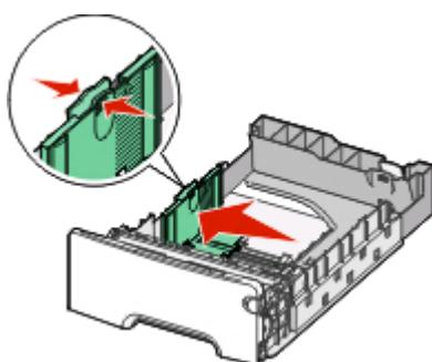
**Bemærk!** Brug størrelsesindikatorerne i bunden af skuffen til at placere styrene det rigtige sted.
