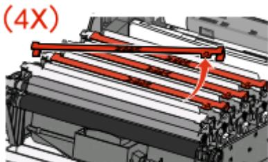
Fjern den røde forpakningsstrip fra toppen af fotokonduktoren.
