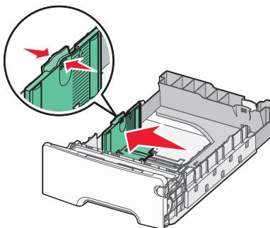
Observe la línea de carga en el lado izquierdo de la bandeja: indica la altura máxima hasta la que se puede cargar papel.
