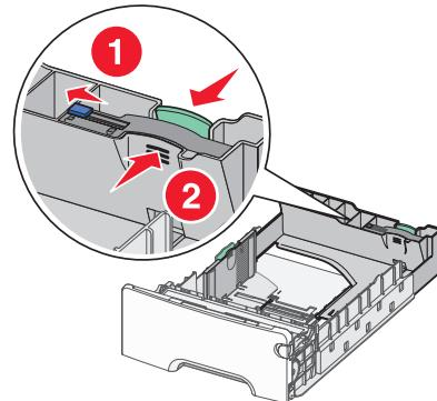
**Nota:** La guía de longitud tiene un dispositivo de bloqueo. Para desbloquear la bandeja, desplace a la izquierda el botón en la parte superior de la guía de longitud como se indica. Para bloquear la bandeja una vez seleccionada la longitud, desplace el botón a la derecha.
