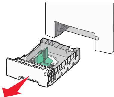
Observe los indicadores de tamaño de la parte inferior de la bandeja. Utilícelos como ayuda para la colocación de la guía.
