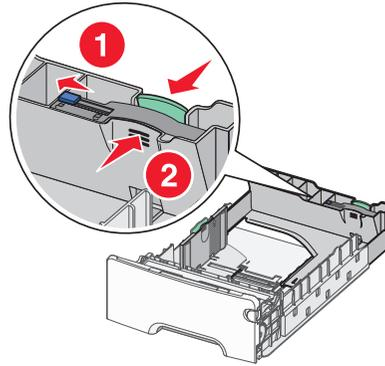
**Remarque :** le guide de longueur est équipé d'un dispositif de verrouillage. Pour déverrouiller le tiroir, faites glisser le bouton situé sur le dessus du guide vers la gauche comme illustré. Pour verrouiller le tiroir une fois la longueur sélectionnée, faites glisser le bouton vers la droite en position initiale.
