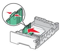
用紙カセットの左側にあるセットラインに注意してください。こ のラインは、用紙をセットできる最大の高さを示します。 **3** 長さガイドタブを締め付け、セットする用紙のサイズに適した位置にスライドさせます。
