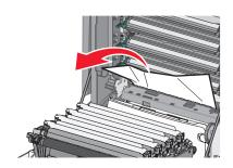
• 詰まった用紙が前面ドアと転送モジュールの間にある場合 は、リリースレバーを引っ張り出して前面ドアを分割できる ようにし、用紙をまっすぐに引き出して取り除きます。
