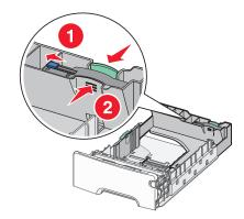
**メモ**: 長さガイドにはロックデバイスがあります。カセットのロックを解除するには、図のように長さガイドの上部にあるボタンを左にスライドさせます。長さを選択した後でカセットをロックするには、ボタンをスライドさせて右に戻します。
