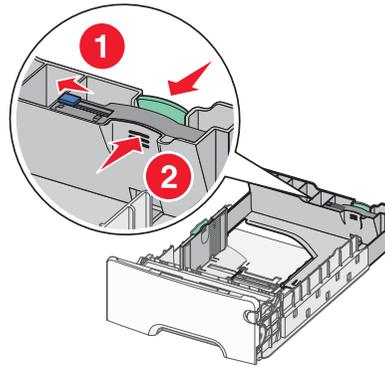
**Nota:** A guia de extensão tem um dispositivo de bloqueio. Para desbloquear a bandeja, deslize a parte inferior sobre a parte superior da guia de extensão para a esquerda, conforme mostrado. Para bloquear a bandeja depois que se escolher a extensão, deslize o botão novamente para a direita.
