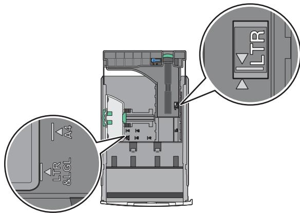
**3** Presione y deslice la guía de longitud hacia la posición que corresponda al tamaño de papel que vaya a cargar.
