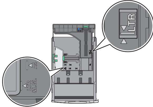
3 压住长度导片并将它滑动到与您加载的纸张尺寸相符的正确位置上。
