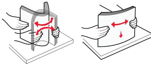
5 将纸堆对着进纸匣的后部放入，并让推荐的可打印面朝上。
