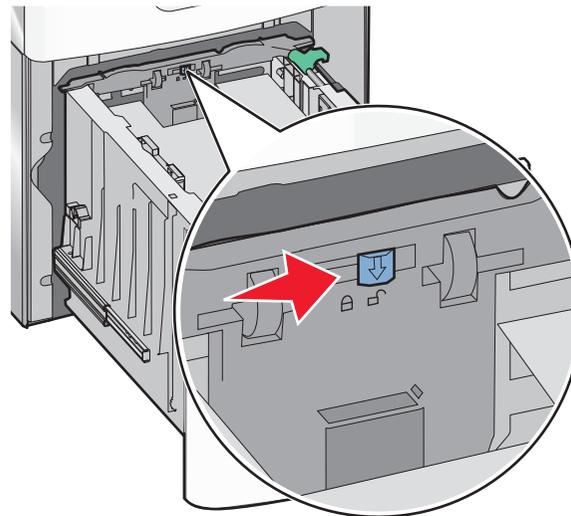
4 Drücken Sie auf die Entriegelung der Längsführung, um die Längsführung anzuheben. Schieben Sie die Führung in die für das eingelegte Papierformat vorgesehene Position und stellen Sie die Führung wieder fest.
