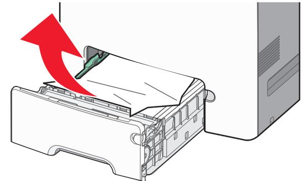
**Hinweis:** Stellen Sie sicher, dass alle Papierteile entfernt werden.
