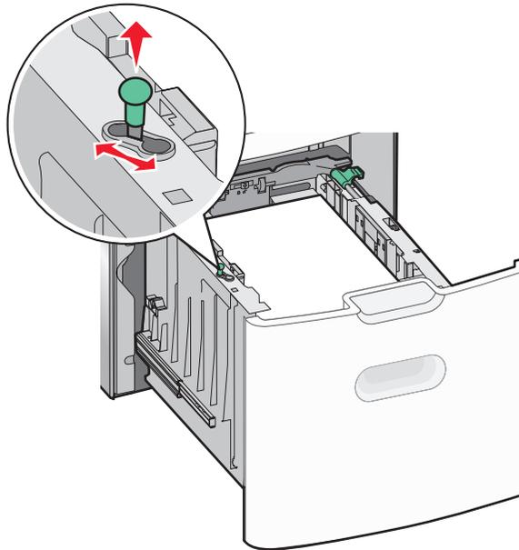
3 Schieben Sie die Taste der Längsführung nach rechts, um die Arretierung zu lösen.
