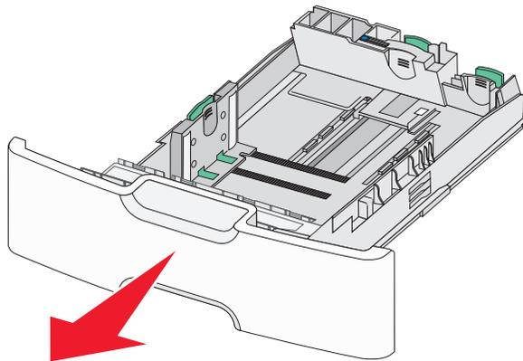
2 Drücken Sie die Führungshebel zusammen und schieben Sie die primäre Längsführung in Ihre Richtung, bis sie stoppt.
