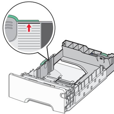
**Warnung - Mögliche Schäden:** Durch ein Überladen des Papierfachs können Papierstaus und Schäden am Drucker auftreten.
