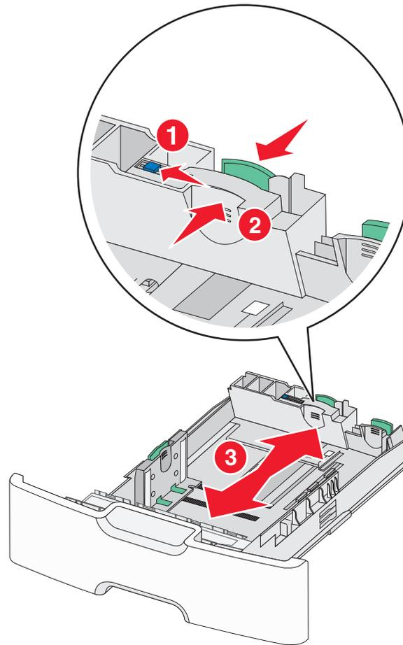
3 Drücken Sie die Seitenführungshebel zusammen und schieben Sie sie in die für das Papierformat vorgesehene Position.
