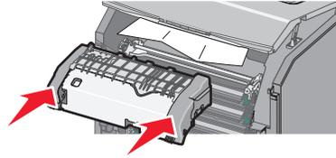
2 Drehen Sie die Schrauben im Uhrzeigersinn, um die Fixierstation sicher zu befestigen.
