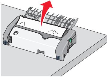
h Schließen Sie die obere Papierführung. Stellen Sie sicher, dass beide Seiten der Papierführung ordnungsgemäß befestigt sind.
