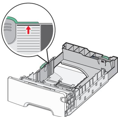
**Attention — Dommages potentiels :** La surcharge du bac peut provoquer des brouillages du papier et endommager l'imprimante.
