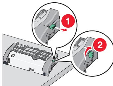
**f** Pressione a guia de seta verde para a esquerda e, em seguida, levante a guia de papel superior.
