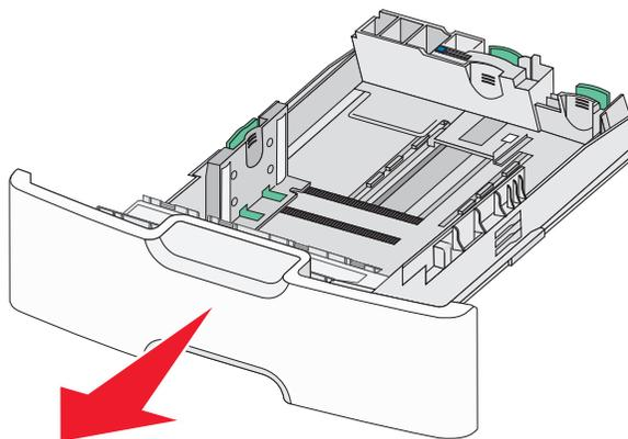
2 Aperte e depois deslize a guia de comprimento principal para a sua direção até que ela pare.
