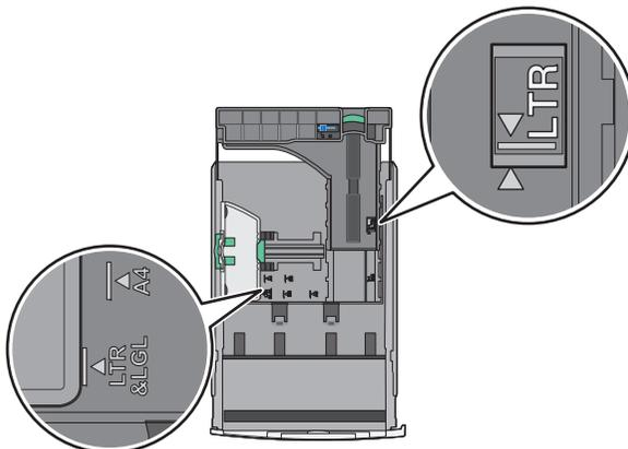
3 Aperte e depois deslize a guia de comprimento até a posição correta para o tamanho do papel sendo colocado.
