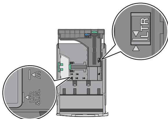
**3** Appuyez sur le guide de longueur et faites-le glisser de façon à l'ajuster au format du papier chargé.
