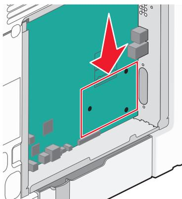
**Nota:** se attualmente è installato un ISP opzionale, è necessario installare il disco fisso della stampante sull'ISP.
