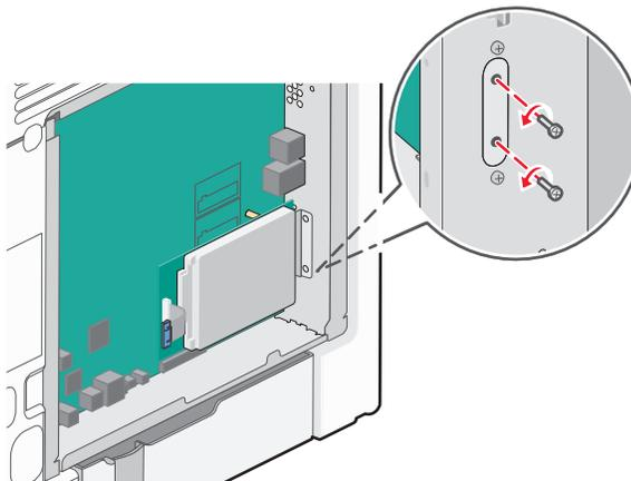
**c** Installare il disco fisso della stampante sull'ISP:
