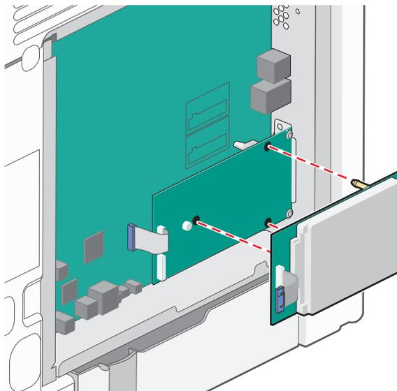
**d** Inserire la spina del cavo di interfaccia del disco fisso della stampante nella presa della porta ISP.
