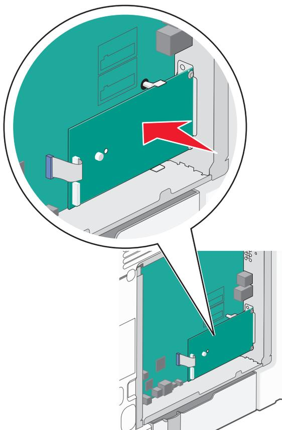
**c** Utilizzare la vite fornita per fissare la staffa in plastica alla soluzione ISP.
