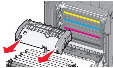
**d** Coloque el fusor en una superficie plana con los tornillos azules mirando hacia usted.
