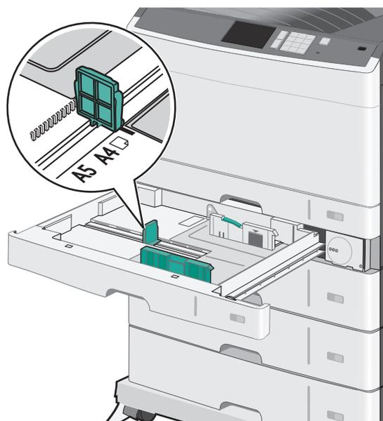
2 Destrave a lingueta da guia de largura na parte traseira da bandeja. Aperte as abas da guia de largura uma em direção à
