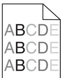
Sostituire i fotoconduttori.
