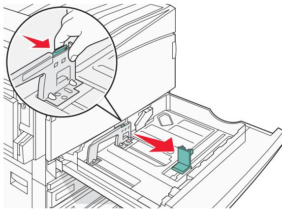
**注意:** 使用进纸匣底部尺寸指示器来帮助放置导片。
