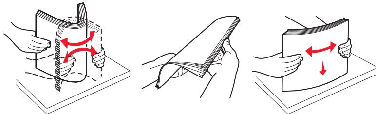
**5** 装入纸堆，让推荐的打印面朝上。如下图所示，按长边或短边方向加载纸张：
