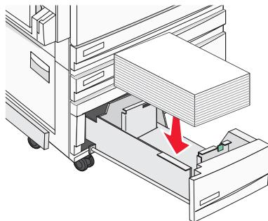
5 确认纸张导片稳定地靠着纸张的边缘。
