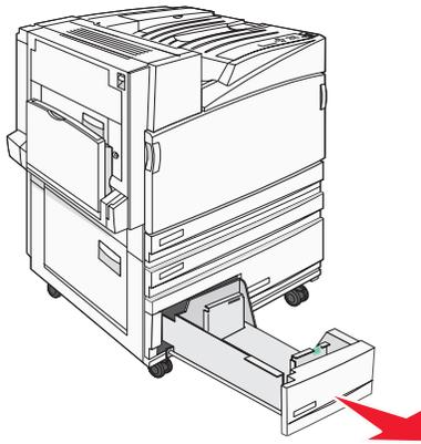
2 如圖所示，將長度導引夾定位拉片朝內捏住，配合所載入的紙張尺寸，將導引夾滑到正確的位置。
