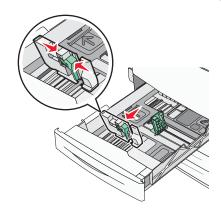
3 Drücken Sie die Längenführung zusammen und schieben Sie sie in die für das eingelegte Papier vorgesehene Position.
