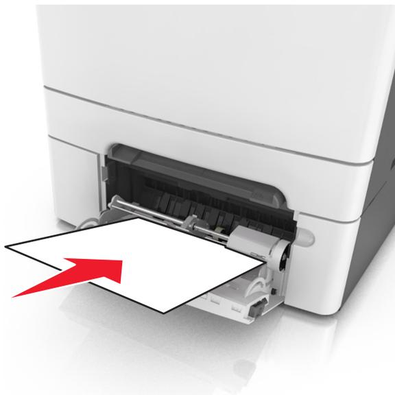
4 Faites glisser le guide papier jusqu'à ce qu'il repose légèrement sur le bord de la pile de papier.
