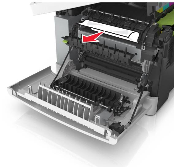
5 Deslice y sujete el pestillo de liberación del lado derecho de la impresora y, a continuación, cierre lentamente la puerta superior.
