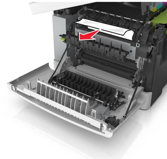
4 Deslize e segure a trava de liberação da na lateral direita da impressora e, devagar, feche a porta superior.
