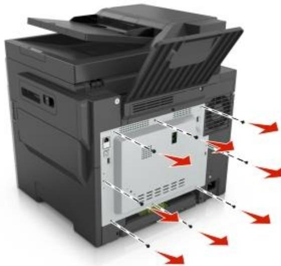
2. Mierne otvorte prístupový kryt riadiacej dosky a jeho posunutím doprava ho vyberte.
