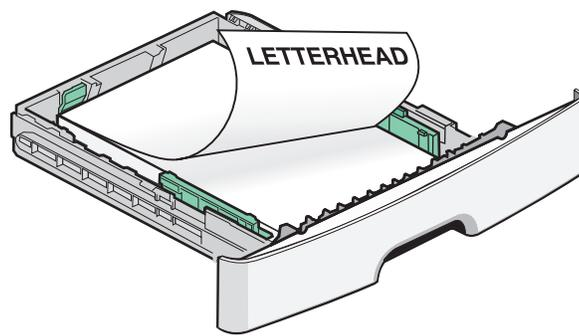
**6** Drücken Sie die Seitenführungsschienen an der rechten Führungsschiene zusammen, so dass der Papierstapel leicht berührt wird.
