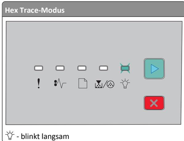
Stellen Sie sicher, dass der Drucker sich nicht im Hex Trace-Modus befindet. Wenn die Signalfolge für den Hex Trace-Modus angezeigt wird, müssen Sie erst den Hex Trace-Modus beenden, bevor Sie Ihren Auftrag drucken können. Schalten Sie den Drucker aus und wieder ein, um den Hex Trace-Modus zu beenden.
