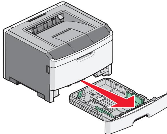
Entfernen Sie keine Fächer, wenn ein Druckauftrag ausgeführt wird oder die Belegt-Signalfolge auf der Bedienerkonsole des Druckers angezeigt wird. Dies kann zu einem Papierstau führen.
