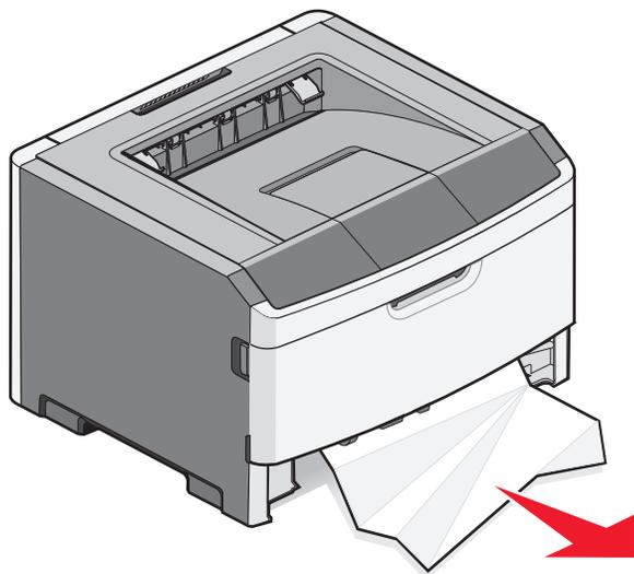
3 Drücken Sie gegebenenfalls auf den Hebel, um das Papier zu lösen. Entfernen Sie dann das gestaute Papier.
