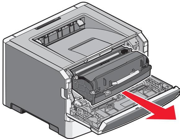
**Warnung - Mögliche Schäden:** Berühren Sie nicht den Fotoleiter an der Unterseite des Fotoleiter-Kits. Verwenden Sie beim Umgang mit der Druckkassette den Griff an der Druckkassette.
