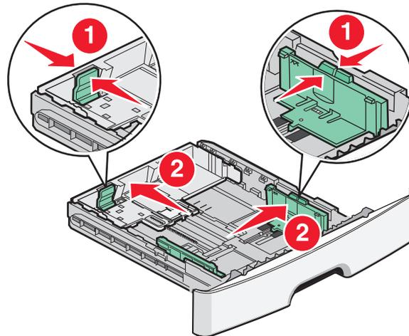
Wenn Sie ein längeres Papierformat einlegen als A4 oder Legal, drücken Sie die Längführungsschienen zusammen, und schieben Sie die Längführung in die für das eingelegte Papier vorgesehene Position. Das Fach wird nach hinten verlängert.
