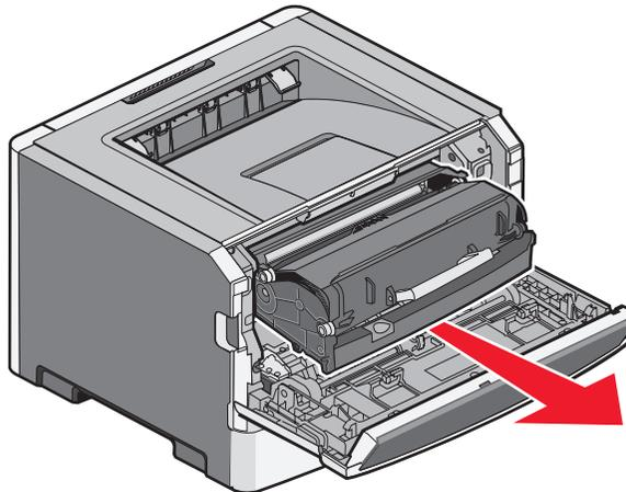
**Advertencia—Posibles daños:** No toque el fotoconductor en la parte inferior del kit del fotoconductor. Utilice la palanca del cartucho siempre que lo sujete.
