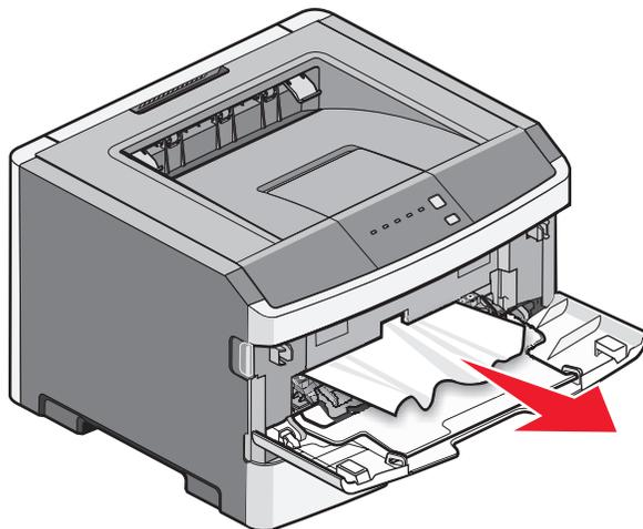
El papel atascado en el alimentador manual normalmente se puede extraer sujetándolo y tirando de él. Si no puede eliminar el atasco de esta forma, compruebe si hay papel atascado detrás del kit del fotoconductor y de la unidad de cartucho de tóner. Para obtener más información, consulte "Eliminación de atascos detrás del kit del fotoconductor y el cartucho de tóner" en la página 7.
