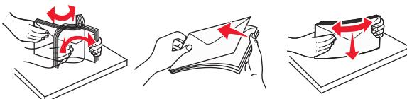
**注意：** 扇形展开信封能防止信封边缘粘连在一起。这样也有助于正确送入信封并避免卡纸。不要折叠或弄皱信封。
