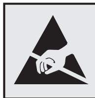
本符號指出易受靜電傷害的組件。請先觸摸印表機的金屬框架，再觸摸這些符號的附近區域。
