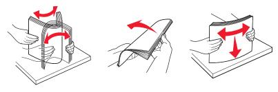
**4** Carregue a pilha de folhas em direção a parte traseira da bandeja, conforme a figura, com o lado para a impressão voltado para baixo.
