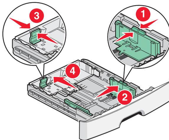
Для длинной бумаги, такой как А4 или, сожмите фиксатор направляющей длины бумаги и сдвиньте ее назад в положение, соответствующее длине загружаемой бумаги.
