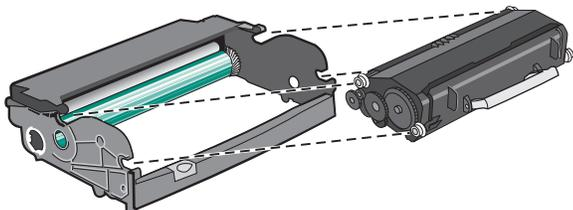
7 Installez l'unité dans l'imprimante en alignant les flèches de guidage de l'unité sur les flèches de l'imprimante. Poussez l'unité au maximum.
