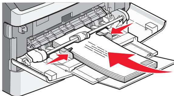
**Attention — Dommages potentiels :** n'utilisez jamais d'enveloppes avec timbre, agrafe, fermoir, fenêtre, revêtement intérieur couché ou bande autocollante. Ces enveloppes peuvent endommager sérieusement l'imprimante.
