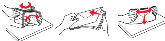
**Remarque :** ventiler les enveloppes permet d'éviter que leurs bords ne se collent les uns aux autres. Cela permet également de les charger correctement évitant ainsi tout bourrage papier. Ne pliez pas les enveloppes et ne les froissez pas.
