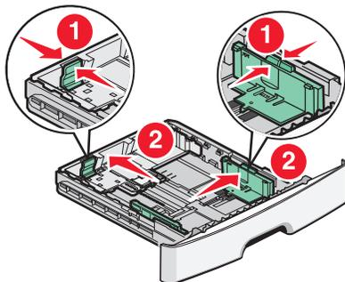
Drücken Sie die Seitenführungshebel wie in der Abbildung gezeigt auf der rechten Führung zusammen und schieben Sie die Seitenführung an den Rand des Fachs. Die beiden Seitenführungen werden gleichzeitig bewegt, wenn Sie nur die rechte Führung bewegen.
