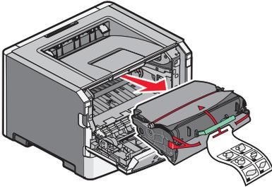
Entfernen Sie die Einheit, bestehend aus Fotoleiter-Kit und Druckkassette, aus dem Drucker.
