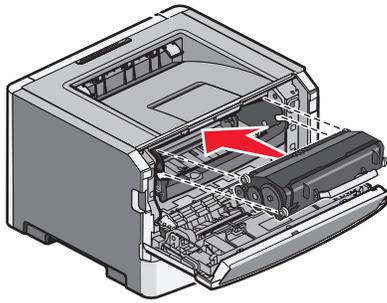
Setzen Sie die neue Druckkassette in das Fotoleiter-Kit ein, indem Sie die Rollen der Druckkassette auf die Schienen des Fotoleiter-Kits ausrichten. Schieben Sie die Druckkassette so ein, dass sie *hörbar* einrastet.
