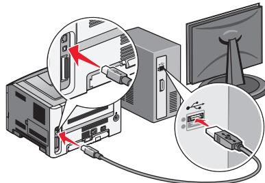
**Merk:** Etter at skriveren er konfigurert vil programvaren gi deg beskjed om å koble fra USB-kabelen, slik at du kan skrive ut trådløst.
