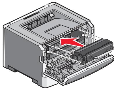
Sett inn tonerkassetten i fotoledersetet ved å sikte inn valsene på tonerkassetten etter sporene. Skyv inn tonerkassetten til den klikker på plass.
