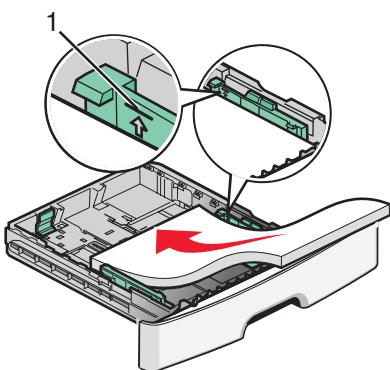
如图所示，将纸堆对着进纸匣的后部放入，并让推荐的打印面朝下。
