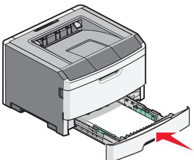
将进纸匣插回打印机中。
