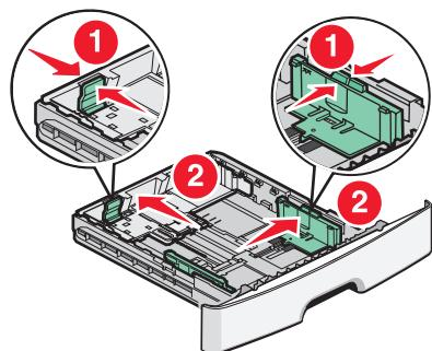
如图所示，压住右导片上的宽度导片凸柱，然后将宽度导片滑动到进纸匣的两边。请注意当您只移动右宽度导片时，两个宽度导片同时移动。
