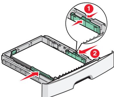
压住右导片上的宽度导片凸柱，然后滑动宽度导片，使它们轻轻地接触到纸堆。
