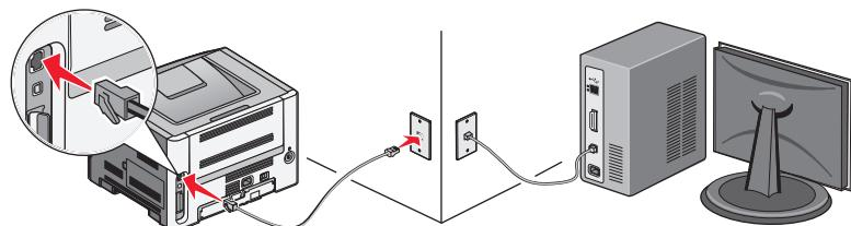
确认您正在用于配置打印机的计算机被连接到与打印机相同的网络上的工作网络端口。
