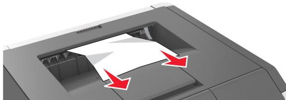
2 Wählen Sie auf dem Bedienfeld **Weiter** > **OK** >, **beseitigen Sie den Papierstau, und drücken Sie auf OK** > **OK**, um die Meldung zu löschen und den Druckvorgang fortzusetzen.
