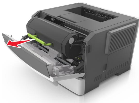
3 Levante la palanca verde y, a continuación, extraiga la unidad de imagen de la impresora.
