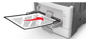
**Notă:** Când încărcați hârtie de dimensiune A6, asigurați-vă că sistemul de extindere al alimentatorului multifuncțional atinge ușor marginea hârtiei, pentru ca ultimele câteva colii de hârtie să rămână fixate.
