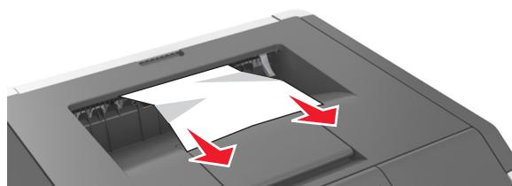
**2** De pe panoul de control, selectați **Next (Următorul)** > **OK** > Îndepărtați blocajul, apăsați pe **OK** > **OK** pentru a șterge mesajul și a continua imprimarea.
