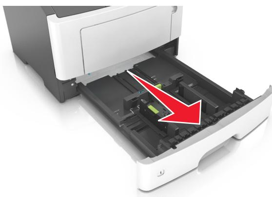
**2** Strângeți și mutați ghidajul pentru lățime în poziția corectă pentru dimensiunea hârtiei pe care o încărcați.
