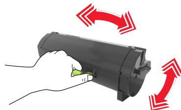
5 将碳粉盒的侧导轨与打印机内部侧导轨上的箭头对齐，然后将碳粉盒插入打印机中。
