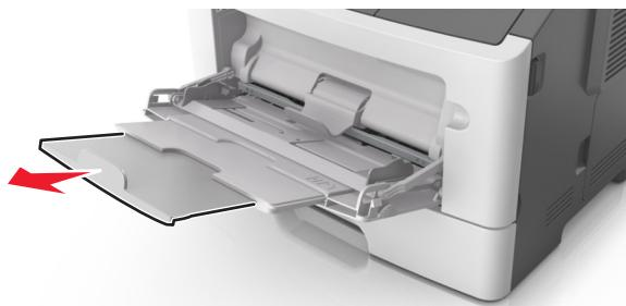
**2** 压住左宽度导片上的凸柱，然后将导片移动到与您加载的纸张相符的位置。
