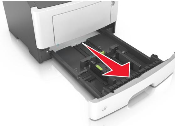
**2** 压住宽度导片凸柱，然后将它滑动到与您加载的纸张尺寸相符的正确位置上。
