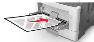
**注意：**当加载 A6 尺寸的纸张时，请确认多功能进纸器扩展板轻轻地靠着纸张的边缘，以使最后几张纸留在原位。
