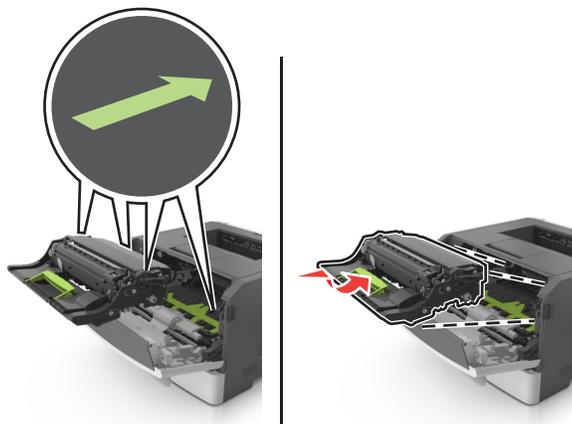
8 插入碳粉匣時，請先將碳粉匣邊欄上的箭頭對準印表機內側邊欄上的箭頭，再將碳粉匣插入印表機。
